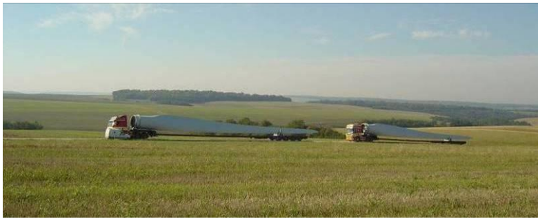
Figure 13 : Exemple de transport de pale par camion
